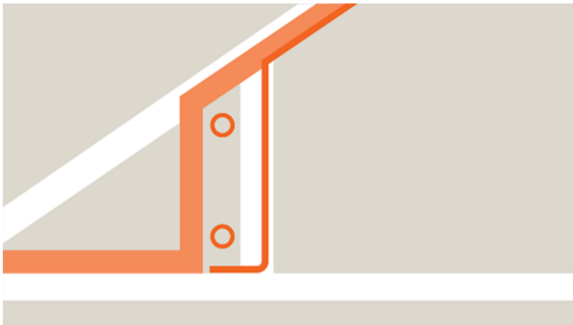
Figur 3.6. Rørinstallation der er korrekt anbragt på den varmeside af isoleringen i et skunkrum
