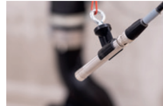
Rumakustisk måling af den udsendte luftbårne lyd fra en Geberit Silent-db20 Sovent fitting.
