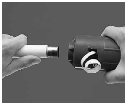
Billede 45: Kobberrør hvor coatingen er fjernet til den angivne indstiksybde "e"
