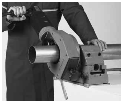
Billede 29: Afkortning af rør i rustfrit Super Size med rørskærer
