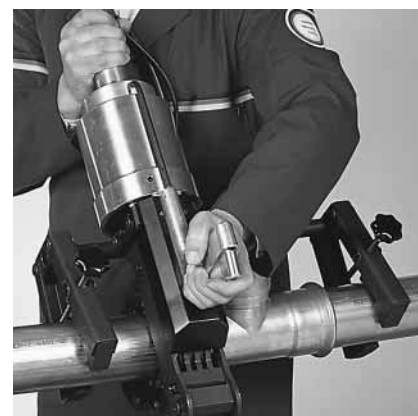
Billede 54: Presning med den elektrohydrauliske pressemaskine HCPS med presseslynge
