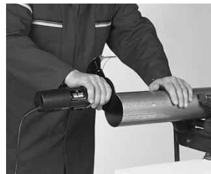
Billede 31: Indvendig afgratning af mapress rør rustfrit og forzinket eller kobberør med den elektriske rørafgrater (også velegnet til udvendig afgratning).
