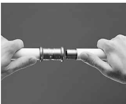
Billede 51: Indføring af et kobberør uden coating i enden og med markeret indstikdybde
