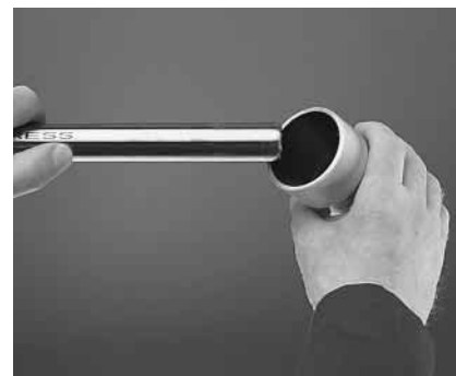
Billede 30: Udvendig afgratning af mapress rør rustfrit og forzinket eller kobberør med en håndafgrater
