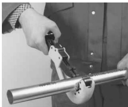
Billede 28: Afkortning af rør i rustfrit med en rørskærer
