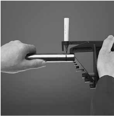
Figur 11: Mærkning af indstiksdybde
