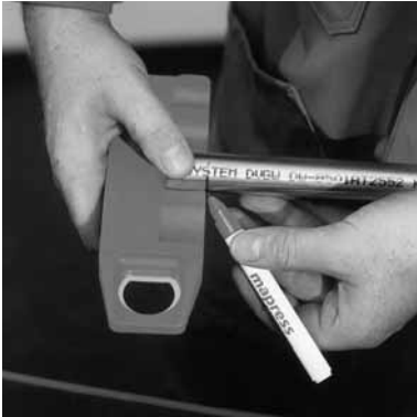
Figur 8: Mærkning af indstiksdybde på systemrøret
