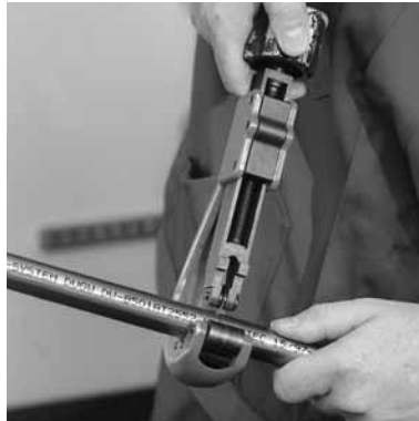
Figur 6: Tilskæring af systemrør i længden med en rørskeer
