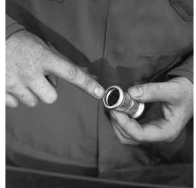
Figur 10: Kontrol af tætningsringen
