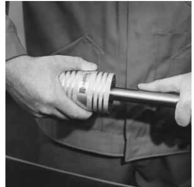
Figur 7: Afgratning af systemrøret udvendigt med en håndafgrater
