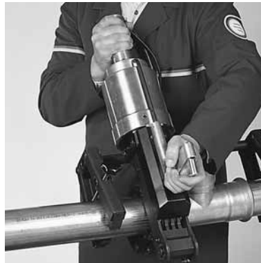
Figur 14: Presning af store dimensioner med HCPS-presværktøj
