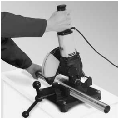
Figur 5: Tilskæring af systemrør i længden med en elektromekanisk sav
